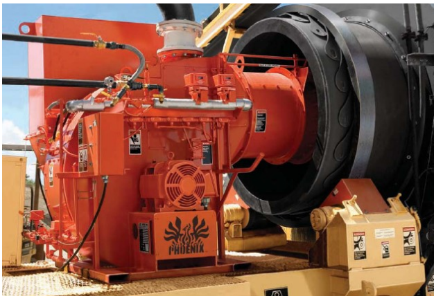
Bild 11: Astec -Kohlestaubbrenner mit direkter KS-Einblasung
