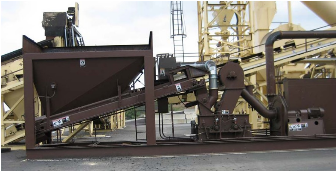
Bild 12: Kohlestaubherstellung, Anlage Astec
