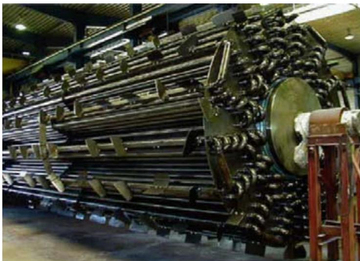
Рис. 4. Внутреннее устройство барабанной паровой сушилки [2]
