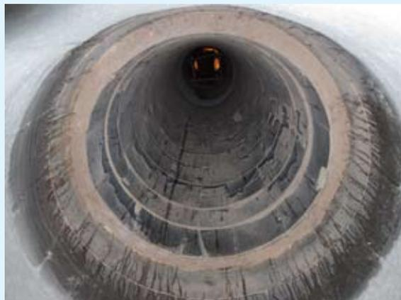
Рис. 2. Противоабразивная защита корпуса вертикальной трубы-сушилки
