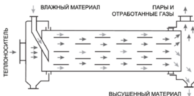
Рис. 2. Схема работы сушильного барабана [3]
