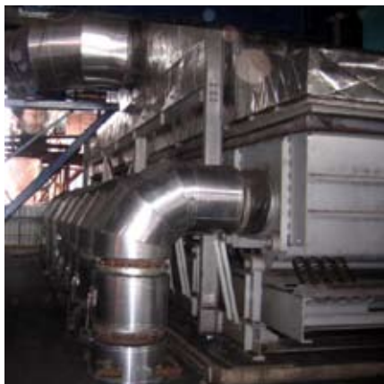
Рис. 7. Подвод горячих газов к сушилке виброкипящего слоя [4]
