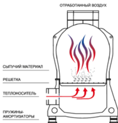
Рис. 6. Схема работы сушилки виброкипящего слоя [4]
