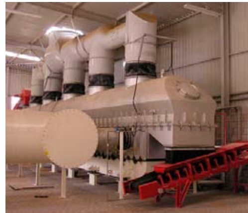
Рис. 8. Установка термической сушилки на основе виброкипящего слоя с псевдооживленным слоем [5]
