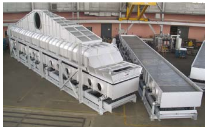
Рис. 5. Сушилка виброкипящего слоя в сборе и без газосборной камеры [4]
