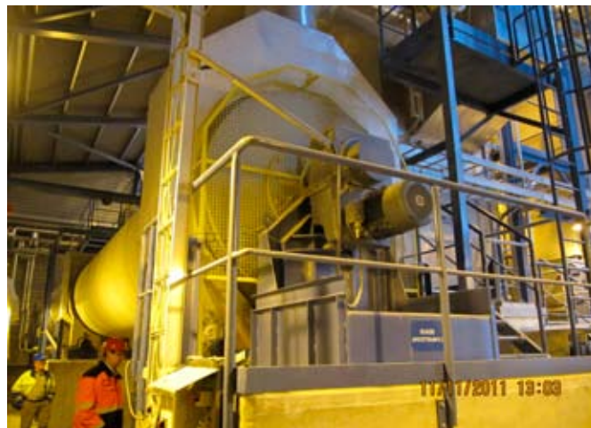
Рис. 1. Торцевая часть сушильного барабана в месте разгрузки материала
