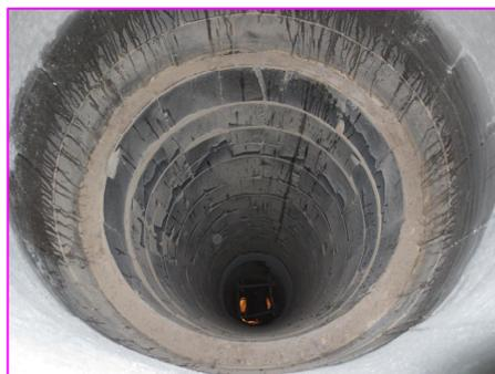
**Аппараты SRT с керамической защитой** от абразивного износа используются для сушки гранулированных шлаков (шлакового песка) с размерами частиц 0,1 – 3 мм и начальной влажностью 8-15%.
